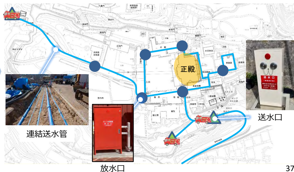
城郭内の連結送水管の放水口に消防ホースを接続して消火活動
