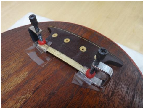
図1 2 クランプによる象牙の押さえ
