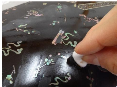
図24 黒漆部分 漆固め
