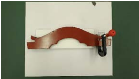
図 4-1 クランプを使用した塗膜押え
