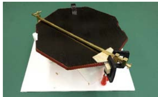
図 4-2 クランプとハタガネを使用した押え
