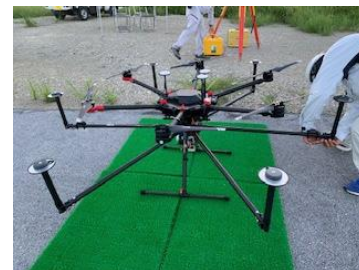
(9/16~9/22) UAVレーザー測量の様子
