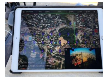
(9/16~9/22) UAVレーザー測量の様子
