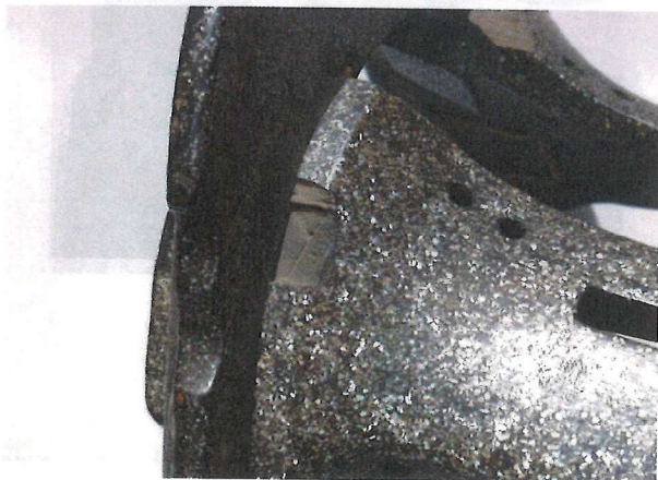
前輪・居木の割損
