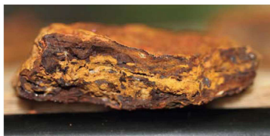
図4 沖縄産「鬼板」サンプル断面像
