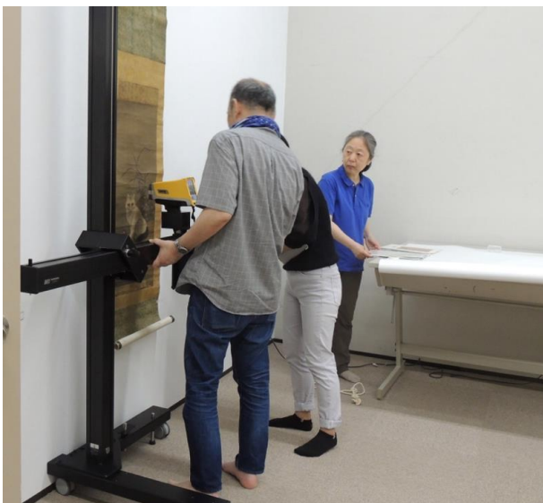
Fig. 50 蛍光X線分析法(XRF)による色材の調査
