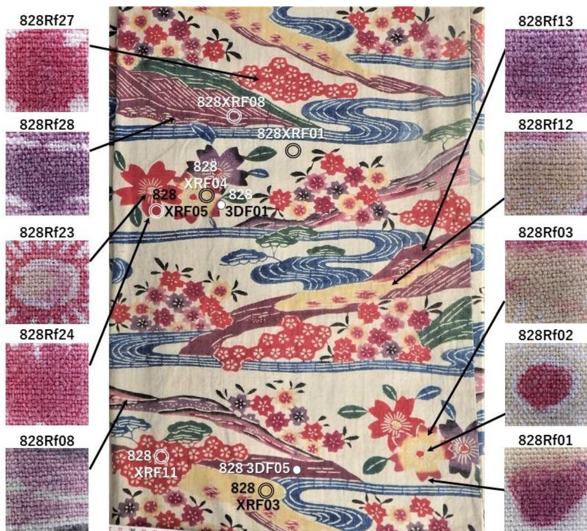
図 1 測定点 (2) 顕微写真中央部：Rf 測定点 ◎：XRF 測定点 ○：3DF 測定点
