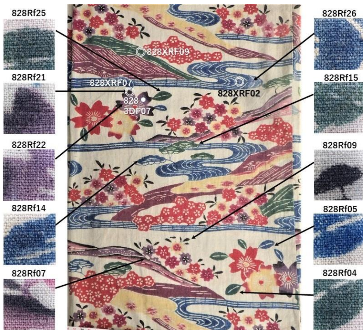
図1 測定点(1) 顕微写真中央部: Rf測定点 ◎: XRF測定点 ○: 3DF測定点
