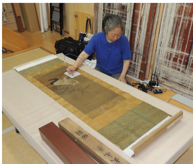
Fig. 51 反射分光分析法による色材の調査
