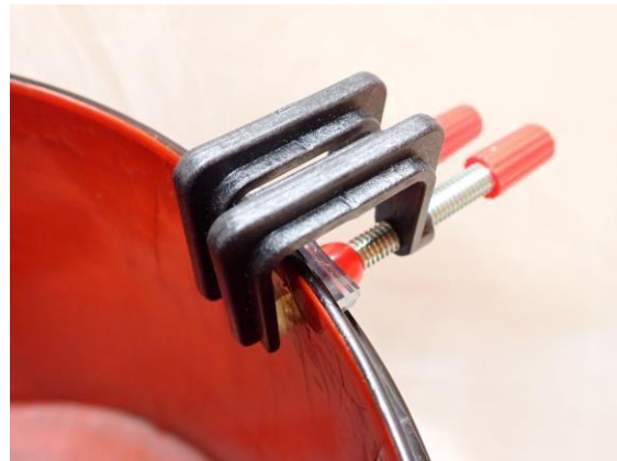
図 23 クランプによる圧着
