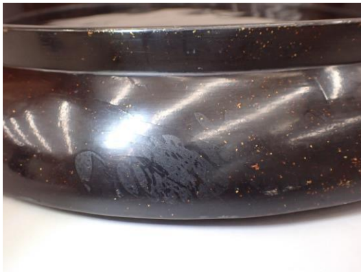
図 3 塗膜表面のシミ汚れ
