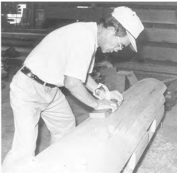
手ガンナによる丸柱の加工
