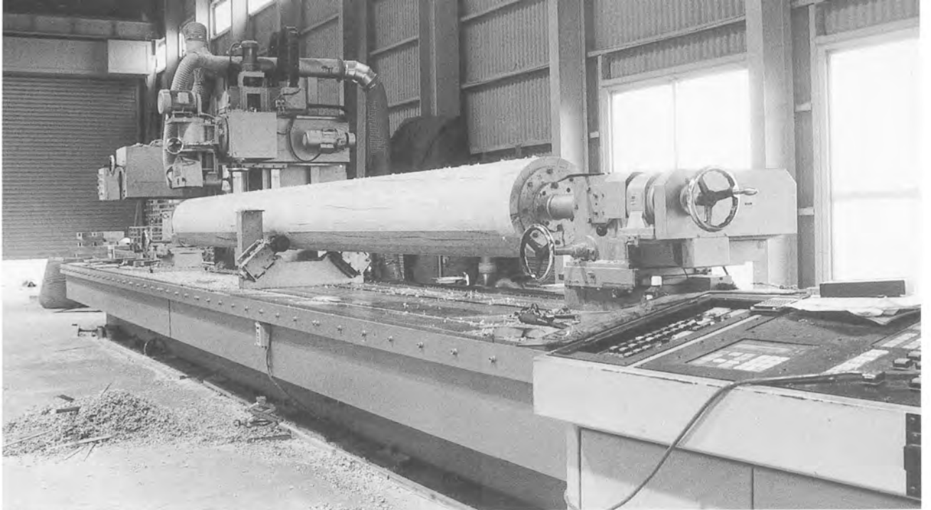
NC（数値制御）付走行鉋盤による柱の加工 手前は操作盤
