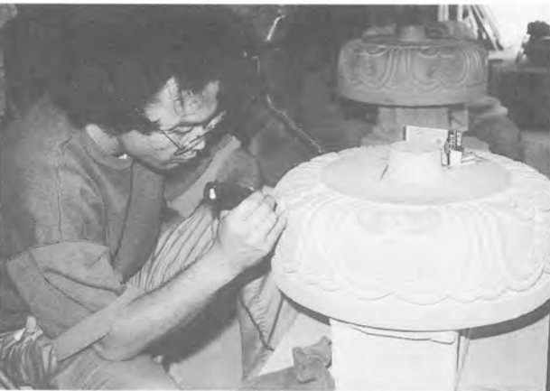
礎盤の加工 蓮弁文様の細かい彫刻はペビーグラインダーで仕上げる
