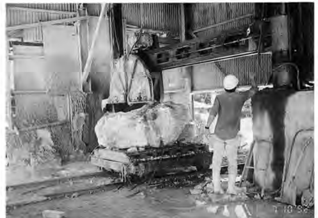
石材工場での荒加工
