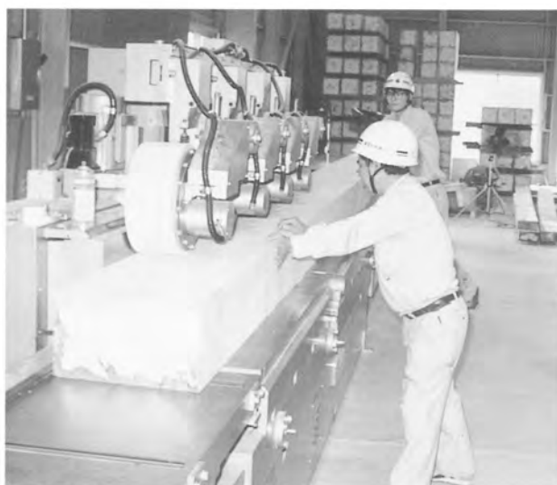
直角自動鉋盤による加工
