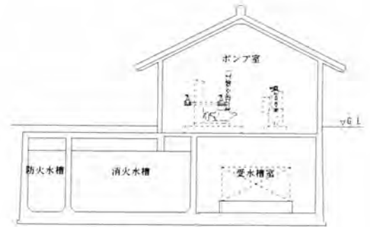
図-4 ポンプ室断面図
