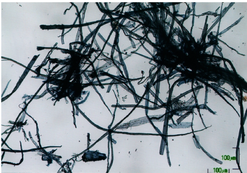
Fig. 66 本紙料紙顕微鏡写真 C 染色液で染色 (高知県立紙産業技術センター 撮影)
