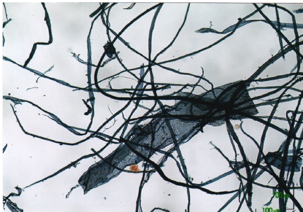
Fig. 68 表装紙顕微鏡写真 C 染色液で染色 (高知県立紙産業技術センター 撮影)
