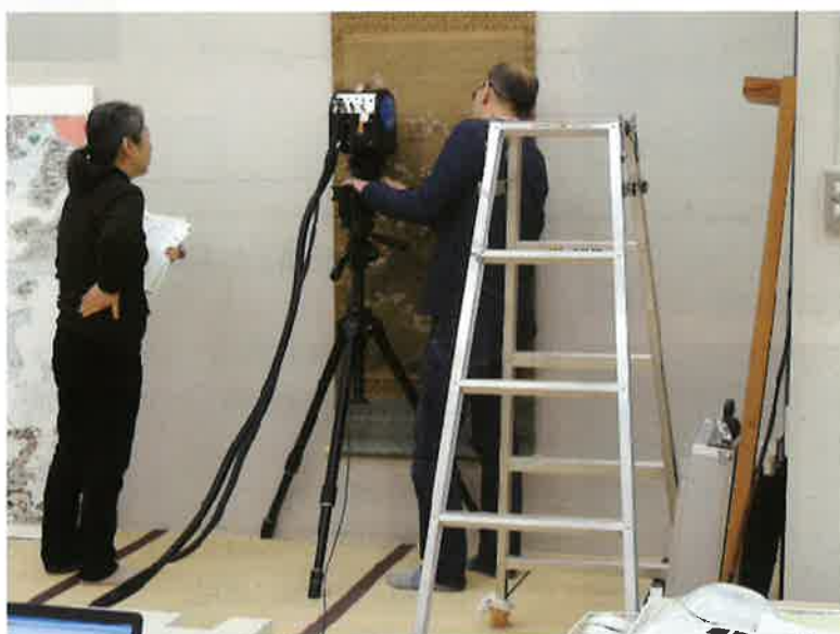
(上)Fig. 38 蛍光X線分析法(XRF)による色材の調査
