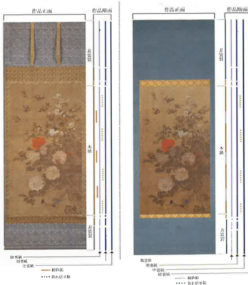
Fig. 59 修復前後 装丁構造図
