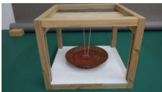
図4-1 木枠を使用した塗膜押え
