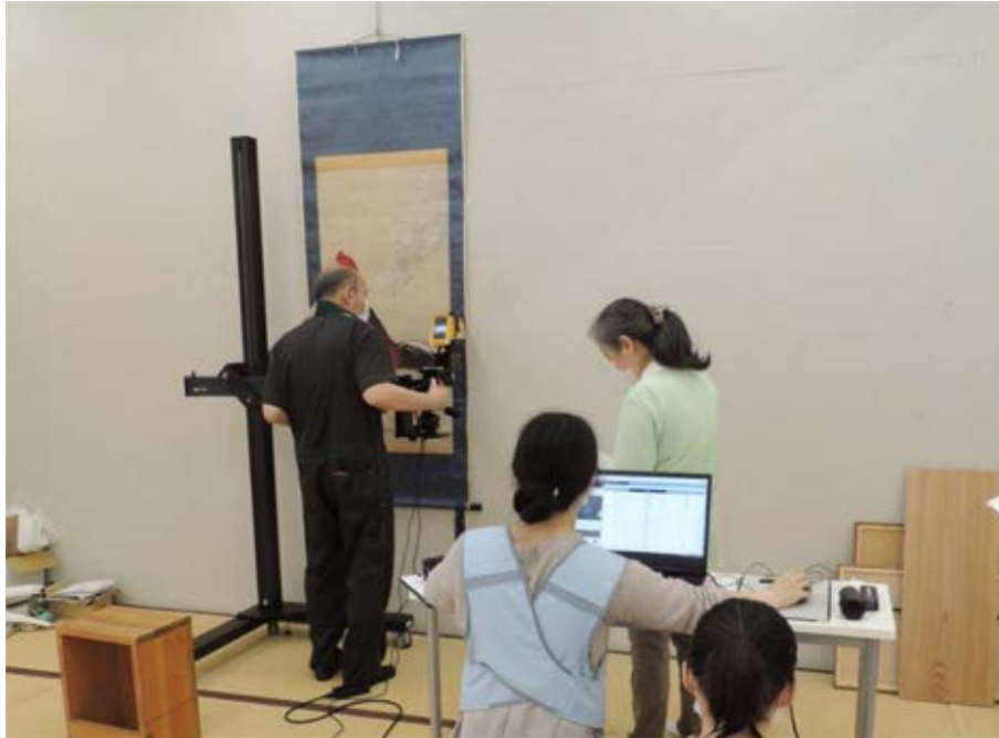
Fig. 30 蛍光X線分析法(XRF)による色材の調査
