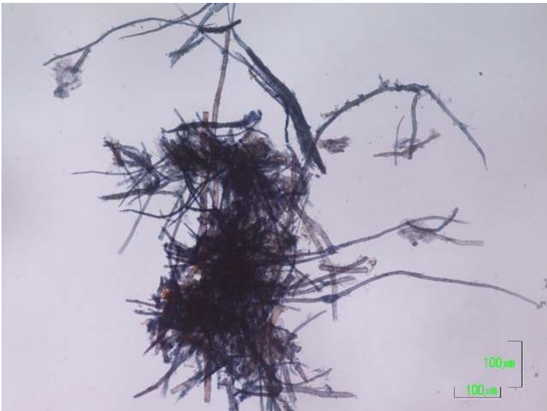
Fig. 49 本紙料紙顕微鏡写真 C 染色液で染色 (高知県立紙産業技術センター撮影)
