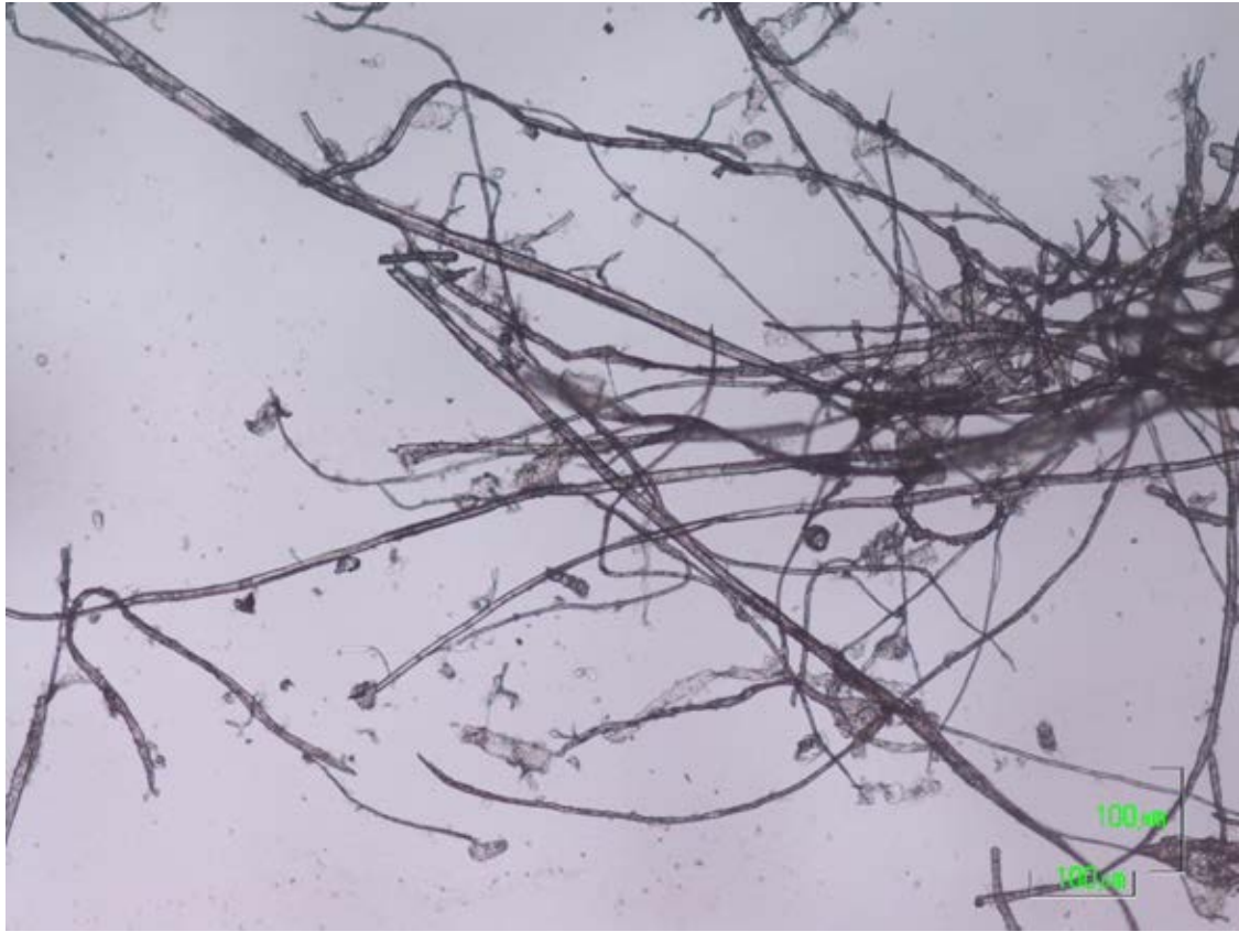
Fig. 50 本紙料紙顕微鏡写真 「青壇繊維、稲わら繊維の混合」 (高知県立紙産業技術センター撮影)
