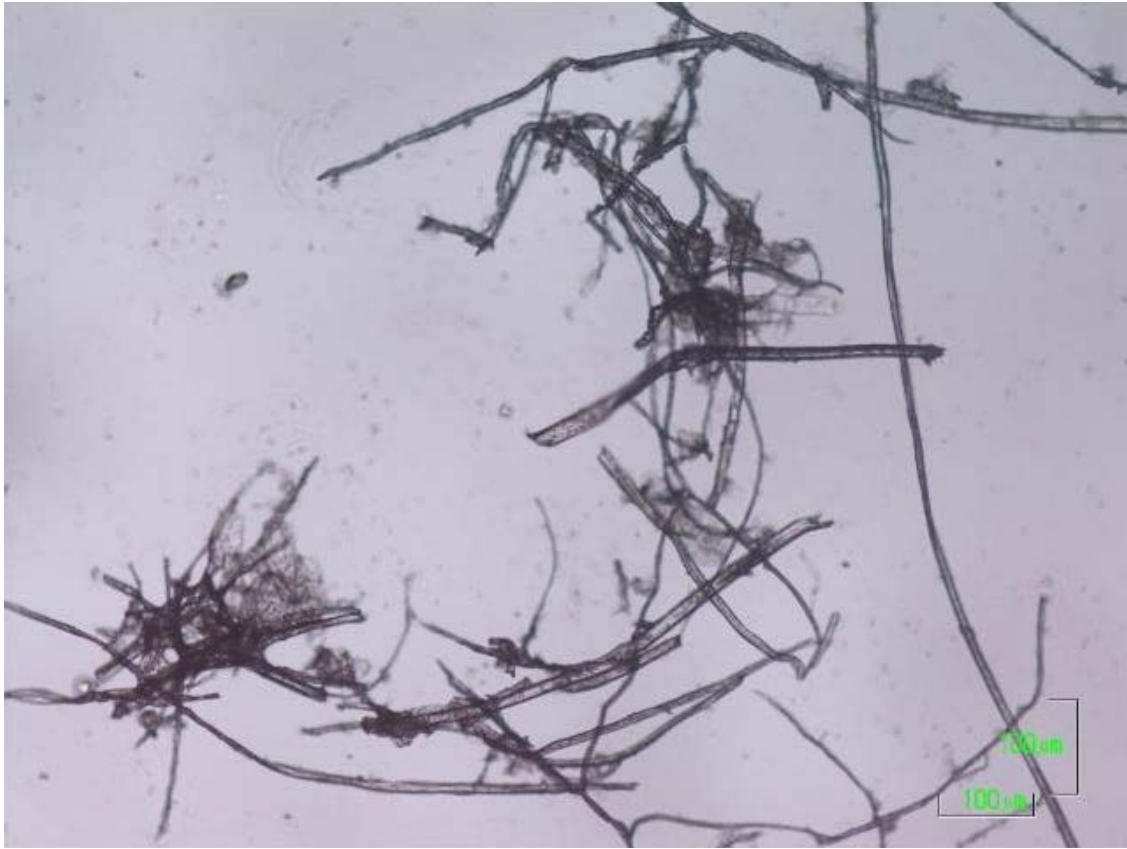
Fig. 48 本紙料紙顕微鏡写真 「青壇繊維、稲わら繊維の混合」 (高知県立紙産業技術センター撮影)
