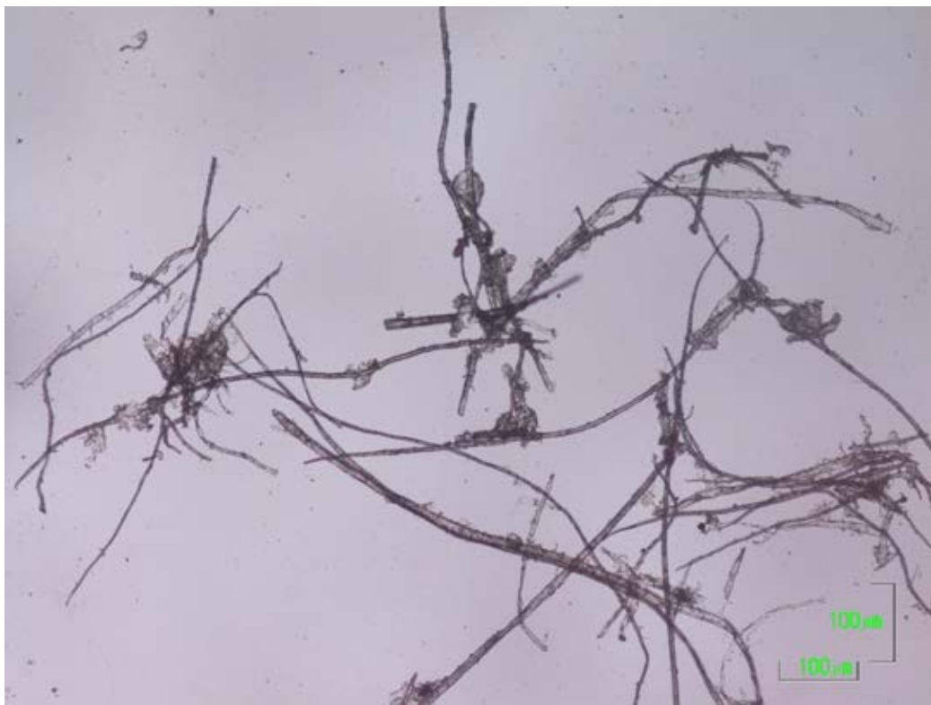
Fig. 56 本紙料紙顕微鏡写真 「青檀繊維、稲わら繊維の混合」 (高知県立紙産業技術センター 撮影)
