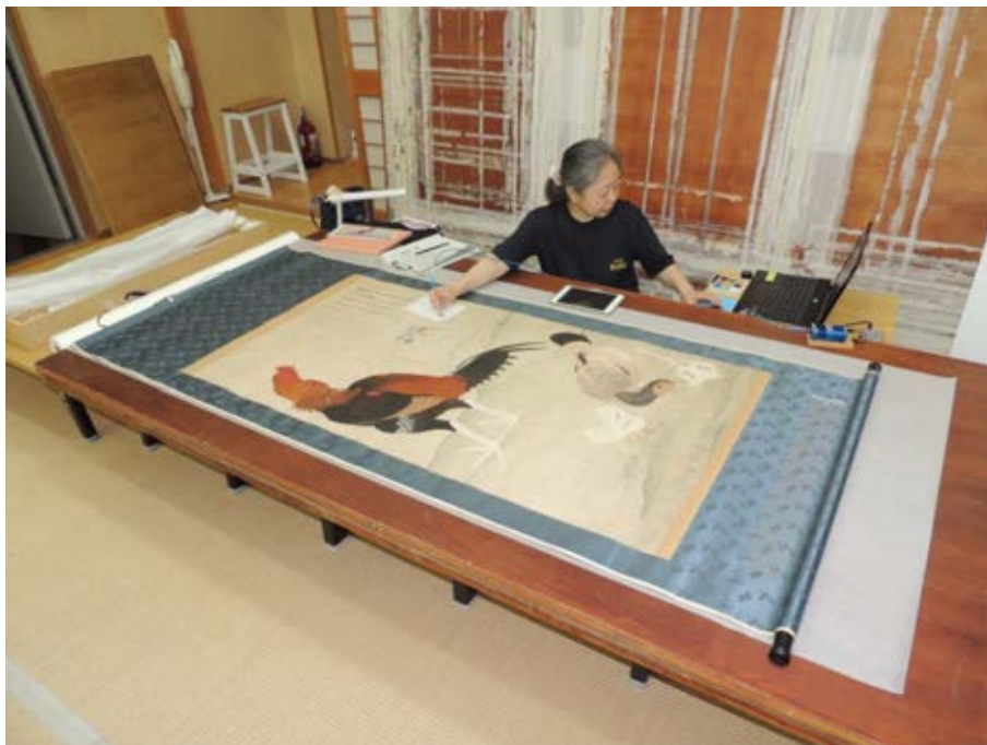
Fig. 31 反射分光分析法による色材の調査
