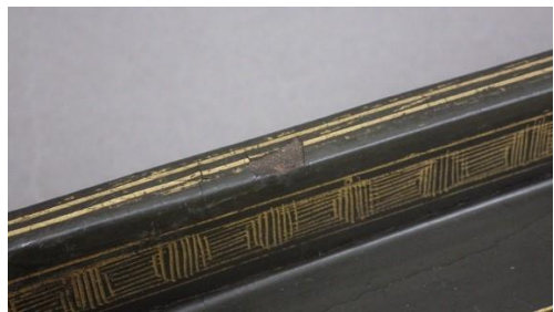
縁の塗膜欠損部 修理前
