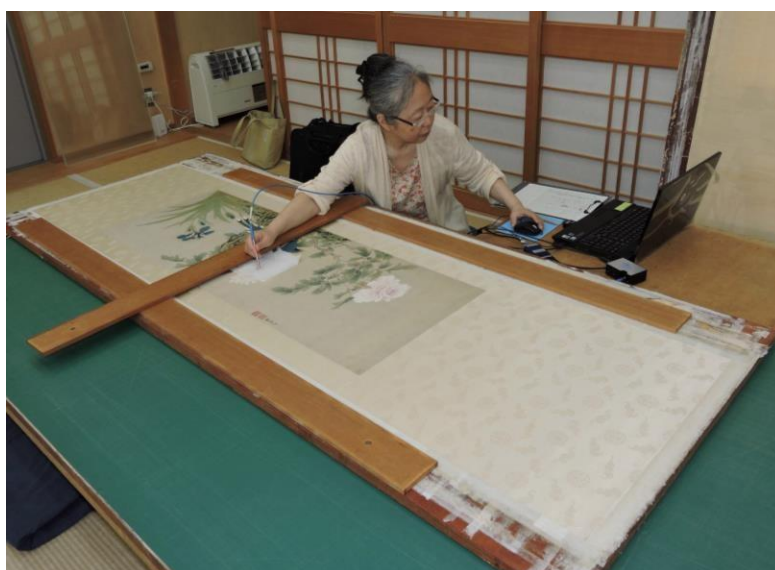
Fig.24 反射分光分析法による色材の調査
