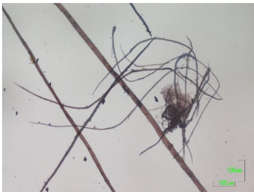
Fig.47 本紙料紙顕微鏡写真 C 染色液で染色 (高知県立紙産業技術センター撮影)
